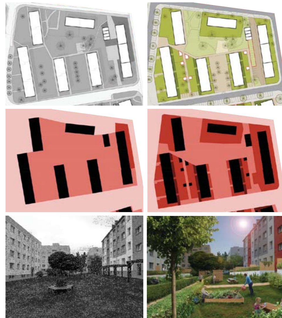
Koncepce úprav sídliště Spořilov v Jilemnici; uspořádání vnitrobloku se zahrádkami; M. Kohout, D. Tichý, F. Tittl, Š. Doležalová, Centrum kvality bydlení (2015); barevné schéma představuje hierarchii míry soukromí v barevné škále od soukromé (nejtmavší), přes polosoukromou, poloveřejnou až po veřejnou (nejsvětlejší)
