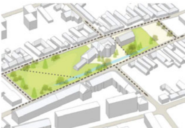
Obr. 59: objekt ubytovne je asanovaný a nahradený hmotovou kópiou zaniknutej časti mlyna, objekt školy je čiastočne asanovaný bez priameho napojenia na objekt sirotinca od Dušana Jurkoviča, aplikácia solárnych zariadení prostredníctvom panelov a článkov len na objektoch v barokovej zástavbe
