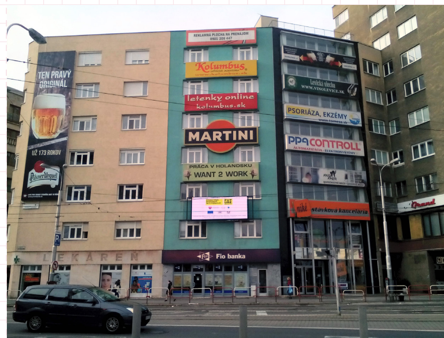
02 Nevhodný príklad fasády zahltenej reklamou rôznych tvarov a nadmernej veľkosti. Reklamné stavby narúšajú svojím umiestnením tektoniku fasády, znižujú estetiku a čitateľnosť jej prvkov, nie sú vo vzájomnom súlade a tiež neladia s fasádou, čím vytvárajú negatívny zážitok z pobytu v príhlom verejnom priestore. Bratislava, Kamenné námestie
