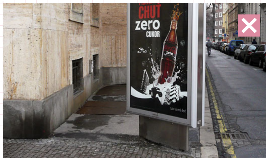
49 Citylight má vzhľadom na smer pohybu chodcov nevhodnú šikmú orientáciu a zároveň neprimerane zužuje priechodnú šírku chodníka. Tvar a farbu citylightu na obrázku neodporúčame. Bratislava, Vajnorská ulica
