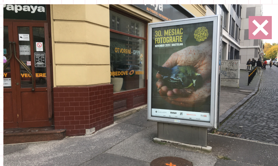
50 Nevhodne umiestnený citylight zužuje priechodnú šírku chodníka, čím obmedzuje pohyb chodcov. Bratislava, Jozefská ulica
