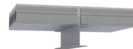
Konštrukcia s ocelovým nosníkom
