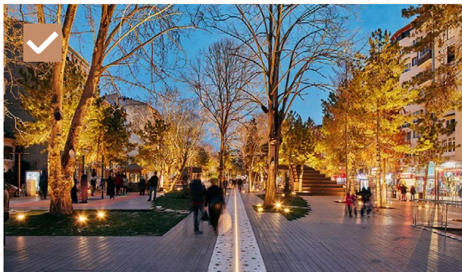
14 Osvetlenie v dlažbe tvorí vodiacu líniu. Zároveň má dekoratívnu funkciu tak ako aj podsvietenie stromov. Obe tvoria doplnkové osvetlenie k štandardnému VO. Turecko, Eskişehir
