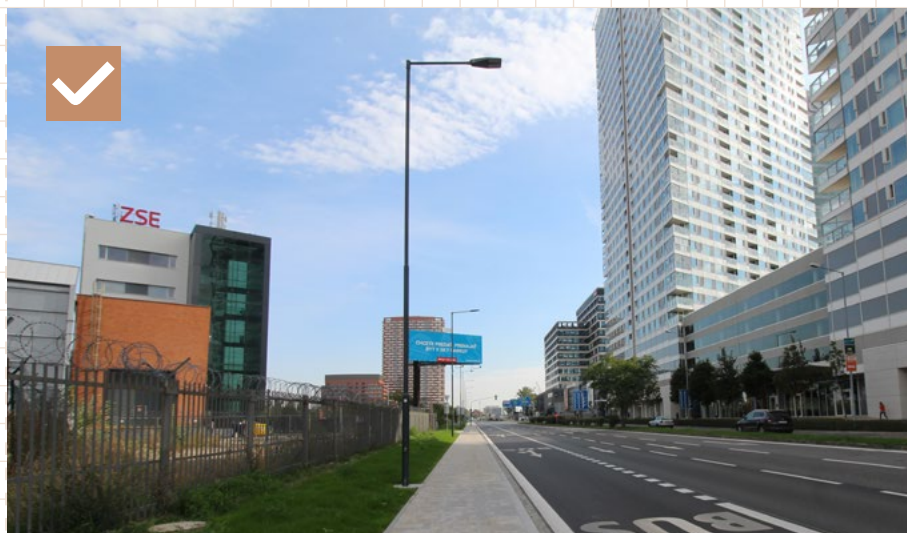
24 Vhodne umiestnené VO v zeleni mimo chodníka, vďaka čomu ostáva zachovaná plná priechodná šírka chodníka. Bratislava, Landererova
