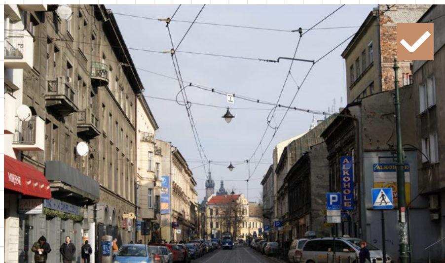
28 Vhodný príklad použitia závesnej osvetľovacej sústavy v užšom profile ulice, kde by použitie štandardných stožiarov mohlo byť zbytočne zužovať šírku chodníkov. Krakov, Poľsko
