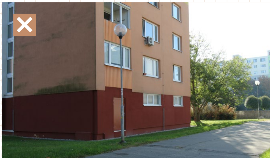
30 Navhodný príklad umiestnenia VO príliš blízko fasády, pričom dochádza k rušivému osvetleniu okien v bytovej budovy. Taktiež je nevhodný dizajn svietidla, ktorý umožňuje vyžarovanie do horného polpriestoru, čím dochádza k prenikaniu svetla do okien bytového domu. Bratislava, Ševčenkova
