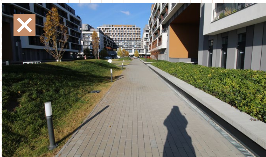
16 Nevhodný príklad použitia stĺpkového osvetlenia ako jediného osvetlenia chodníkov. Uvedený typ osvetlenia je možné používať len ako doplnkové v kombinácii so štandardným VO. Bratislava, Zuzany Chalupovej
