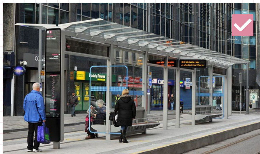
42 Príklad umiestnenia obojstranného prístrešku na obojstrannom nástupišti. Riešenie zachováva dostatočnú minimálnu šírku nástupištia. Zároveň je vhodné, že obojstranný prístrešok má niektoré polia bez zasklenia, čím umožňuje priechy pohyb. Veľká Británia, zastávka Bull Street
