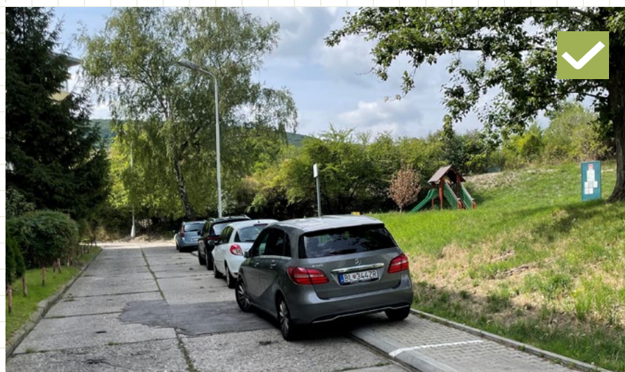
61 Terénna modelácia ako bariéra proti nežiaducemu parkovaniu v zeleni. V tomto prípade sa jedná o prirodzenú, teda nie umelo vytvorenú terénnu modeláciu. Bratislava, Skalická cesta
