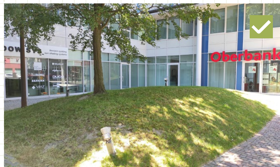
24 Vhodný príklad výsadby v koordinácii s podsvietením korún stromov. Nasvietenie smeruje do koruny stromu smerom od chodca. Bratislava, Prievozska ulica.
