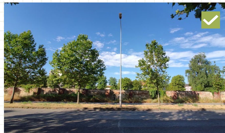
17 Vhodné umístění uličného osvětlení v stromoradií. Osvětlení je umístěné v dostatečné vzdálenosti od stromů a nezasahuje do jejich korun. Bratislava, Jarošova ulica
