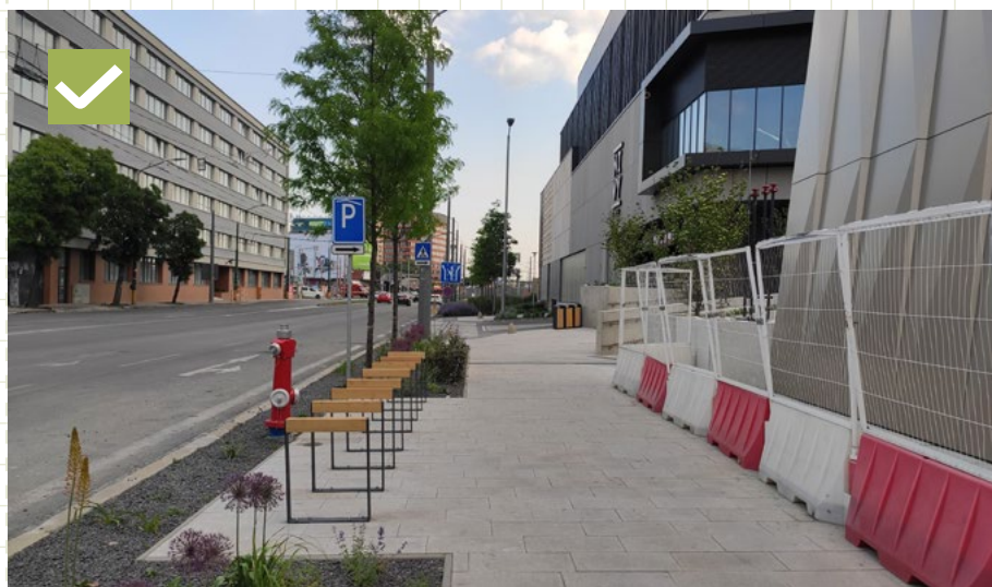
50 Vhodný príklad cyklostojanov osadených v koridore výsadbovej plochy ako súčasť chodníka. Bratislava, Svätoplukova ulica
