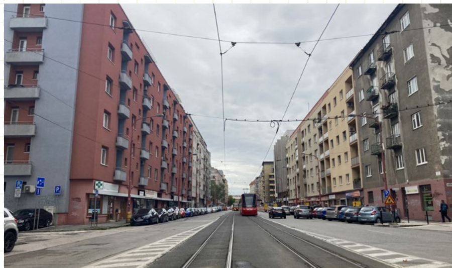
37 Príklad obojsmernej dopravy s električkovou traťou v osi ulice, parkovanie po oboch stranách, bez výsadby. Šírka: do 35 m Bratislava, Krížna ulica
