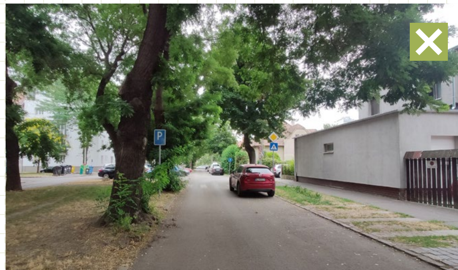
14 Blízkosť vegetácie k ceste obmedzuje rozhľad vodiča na prichádzajúceho /čakajúceho chodca na priechode pre chodcov. Bratislava, Oravská ulica
