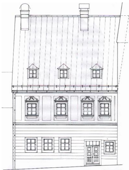
Architektonický návrh na prezentáciu klasicistickej úpravy fasády. Stav fasády po reštaurovaní poslednej klasicistickej úpravy fasády v roku 2003. Neúdržbou strechy došlo vzápätí po reštaurovaní k zatečeniu časti koruny muriva fasády.
