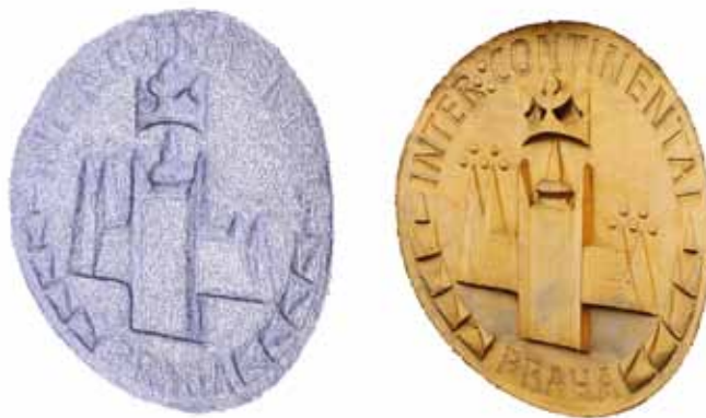
☪ Umístění emblému hotelu na fasádě (vlevo), digitální síťový model vytvořený pomocí fotogrammetrie bez a včetně povrchové textury (vlevo dole), emblém vytištěný na 3D tiskárně (vpravo).
