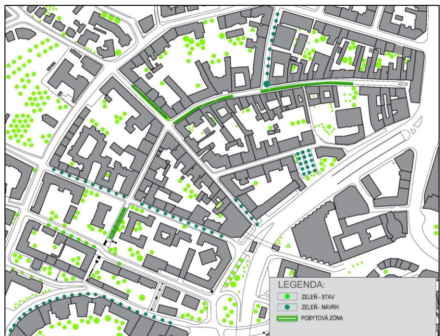
ZELEŇ – NÁVRH DOPLNENIA STROMORADI A UMIESTNENIE POBYTOVÝCH ZÓN CHODNÍKOV SO ZELENÝMI PLOCHAMI A MOBILNOU ZELEŇOU
