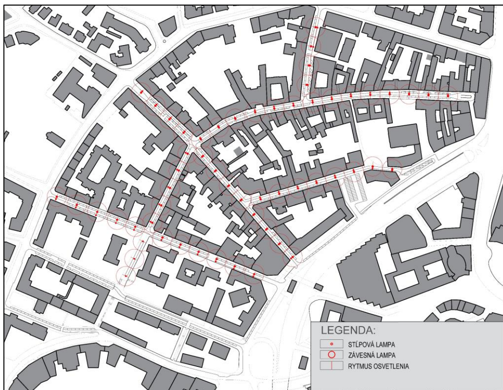
UMIESTNENIE OSVETLENIA ULÍC V ODSUPE 25 METROV
