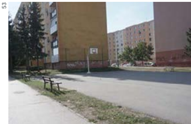
! Sekčov / Ihriská pre loptové hry je vhodné umiestňovať k tupým fasádám objektov. Je však potrebné pristupovať k ich pravidelnej údržbe a na ich povrchy pokiaľ možno používať priepustné povrchy (hrubozrn. tartan).
